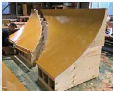
大型舟底型枠
