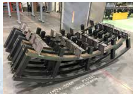
トンネルインバートシステム
